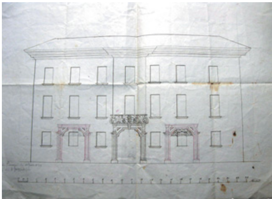
Fig. 5- Progetto per l'apertura di due botteghe al piano terreno del palazzo (secolo XIX)
